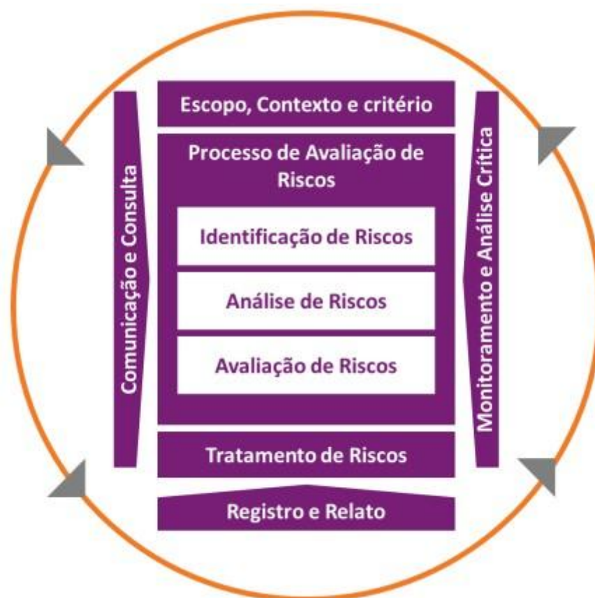
Figura 1 - Processo de Gerenciamento de Riscos
